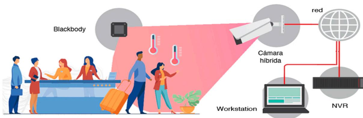
Visualización en tiempo real de las temperaturas medidas a través de la interfaz web de la cámara. El operador actúa en consecuencia permitiendo la comunicación bidireccional con el micrófono y los altavoces a bordo de la cámara para separar a aquellos en riesgo de la multitud. Por encima de un umbral determinado, se puede activar el LED blanco y / o un mensaje de audio de los altavoces.
